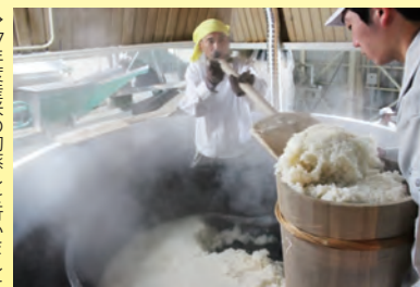
→27年度産米の初蒸しを行いました。瓶（こしき）と呼ばれる大きな蒸し釜に蔵人が入り、大きなヘラですくって杉桶に移しています。
